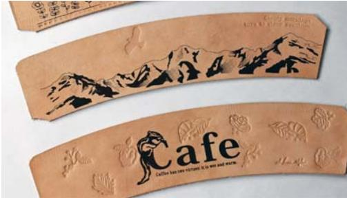
皮革は彫刻には向いていますが、切断の場合はパワーが必要なので、コゲが出やすい素材です。切断をする場合はテスト加工を行い、仕上がりを確認してください。
