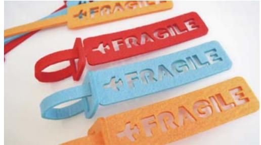
フェルトは熱吸収が多く溶けやすい素材なので細かいデザインは向きませんが、切断速度も早く、加工しやすい素材です。小物雑貨など挑戦してみてください。
